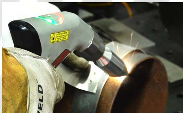
Высокопроизводительный режим очистки до и после сварки
