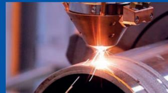
Порошковая наплавка деталей плоского и криволинейного профиля, тел вращения
