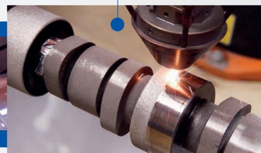
Термоупрочнение резьбы, валов, зубчатых колёс
