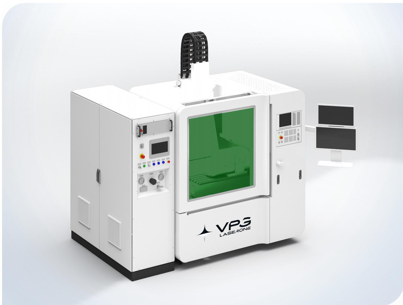
Комплекс гидролазерной резки **FL-HYDRO** – это универсальная 5-и осевая система, предназначенная для множества высокоточных операций резки и сверления с применением технологии гидролазерной резки различных типов материалов в различных отраслях промышленности. Система ЧПУ поддерживает обработку сразу по 5 осям. Станина станка изготовлена из синтетического Диабаза, который лучше гасит вибрации, чем чугун и обладает высочайшей жёсткостью при компактных размерах.
