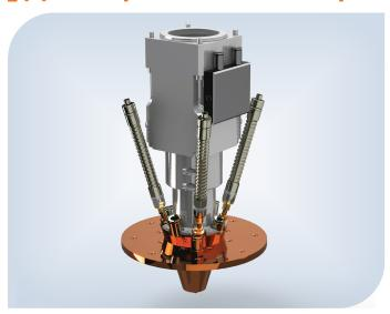
**4-осевая сопловая насадка** предназначена для четырёхсторонней подачи наплавляемого материала и защитного газа в область фокусировки лазерного луча. Насадка полностью совместима с головками FLW D50.
