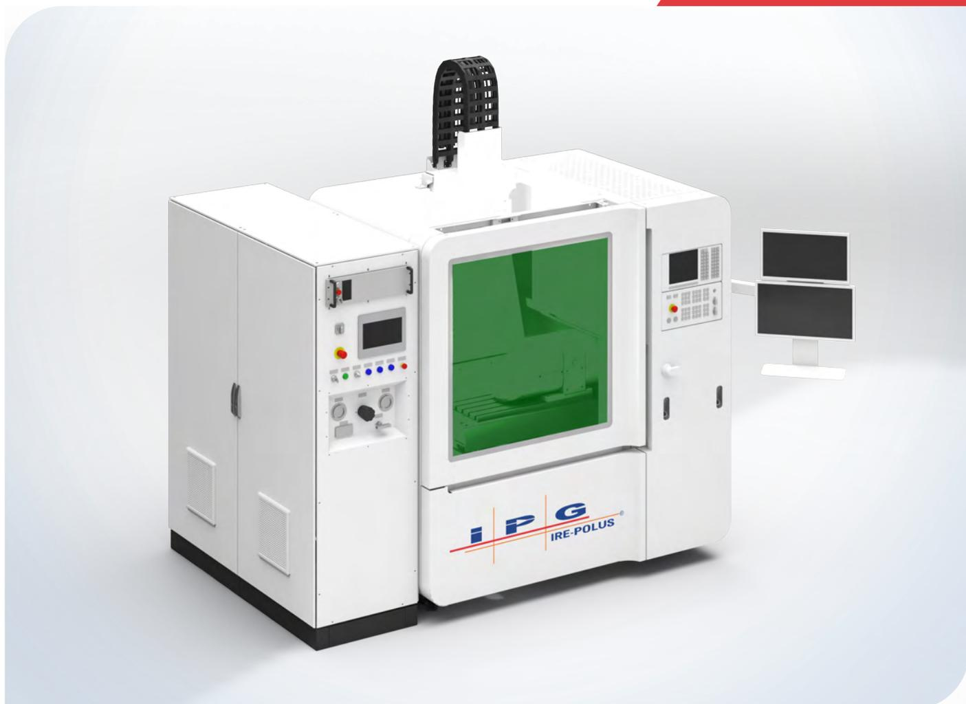
Комплекс гидролазерной резки **FL-HYDRO** – это универсальная 5-и осевая система, предназначенная для множества высокоточных операций резки и сверления с применением технологии гидролазерной резки различных типов материалов в различных отраслях промышленности. Система ЧПУ поддерживает обработку сразу по 5 осям. Станина станка изготовлена из синтетического Диабаз, который лучше гасит вибрации, чем чугун и обладает высочайшей жесткостью при компактных размерах.
