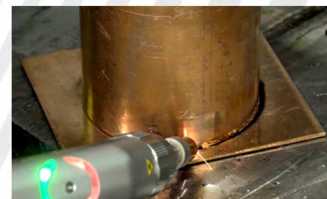
Прочная и герметичная сварка медной трубы толщиной 2 мм к медному фланцу толщиной 3 мм
