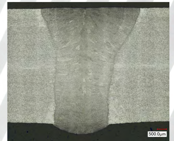
Сварочный шов в поперечном сечении – минимальное тепловложение и максимальное качество сварки
