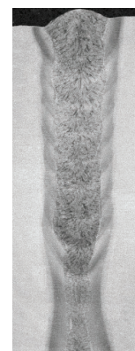
Макрошлиф сварного соединения трубной стали толщиной 27 мм, выполненный по технологии многопроходной лазерной сварки
