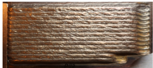
Лазерная наплавка с подачей присадочной проволоки
