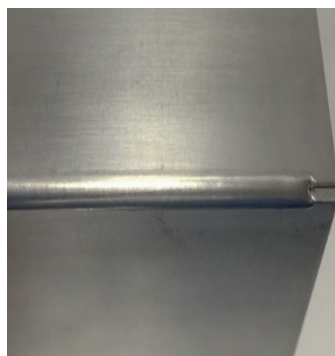
Угловое сварное соединение алюминиевых листов (толщина 1,5 мм). Слева – общий внешний вид получившегося шва, справа – вид шва.
