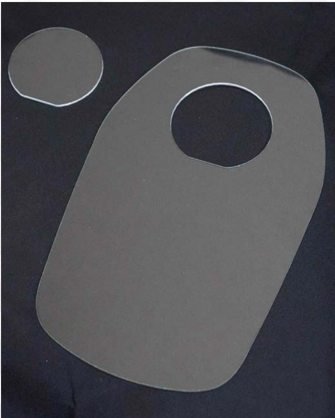
Заготовка 2М1, отверстие D=80 мм
