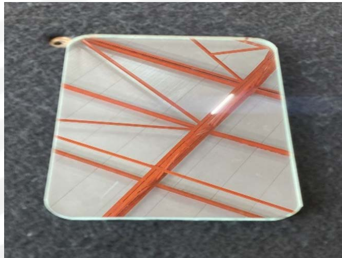
Скругление углов детали 10M1 R=20 мм
