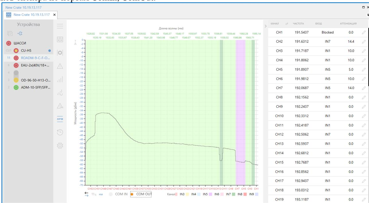
Рисунок 25 - График спектра устройства ROADM-9-C-F-OCM-H8
